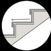
Treppenkonstruktion: Wir empfehlen ein Gefälle von 1–2 % für einen idealen Wasserablauf.
